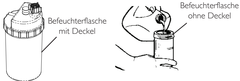
ABBILDUNG 6.1 Auffüllen des Befeuchters
